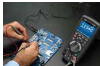
Измерение сопротивления: 50 МОм Измерение емкости: 10 мФ
