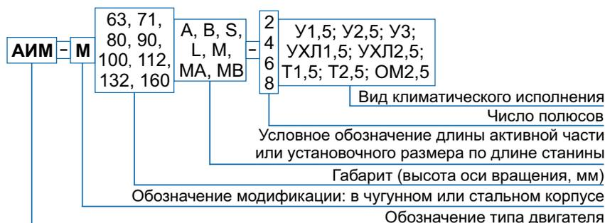
**ТЕХНИЧЕСКИЕ ПАРАМЕТРЫ ЭЛЕКТРОДВИГАТЕЛЕЙ АИМ-М 63-160 НАПРЯЖЕНИЕМ 380В**
